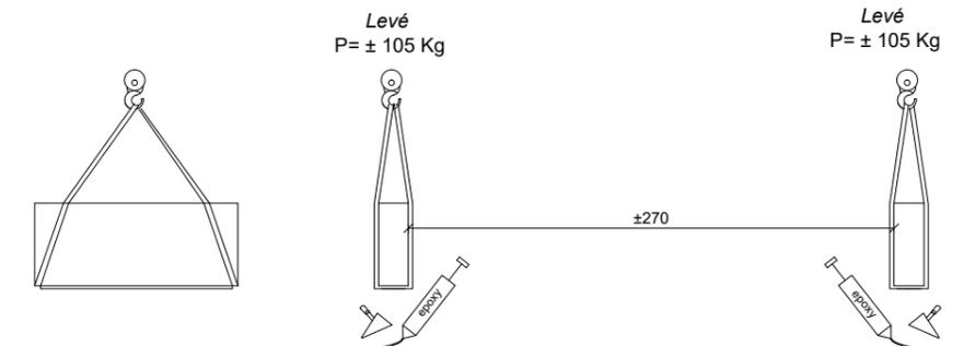
3 verser la résine époxy insérer la tige métallique dans le trou
