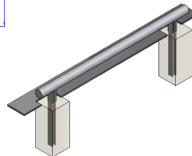
**Chasse roues droit** longueur 1300mm en acier galvanisé à chaud + thermolaquage - hauteur hor sol 140mm - Ø60,30mm - Ensemble mécano-soudé en acier apte à la galvanisation à chaud. - Galvanisation à chaud des produits finis (+/-80 microns), +Thermolaquage, poudre thermodurcissable à base de résine polyester (Minimum 60microns). Mise à la teinte RAL à définir
