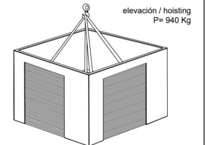
SISTEMA DE ELEVACIÓN / ANCHORAGE SYSTEM
