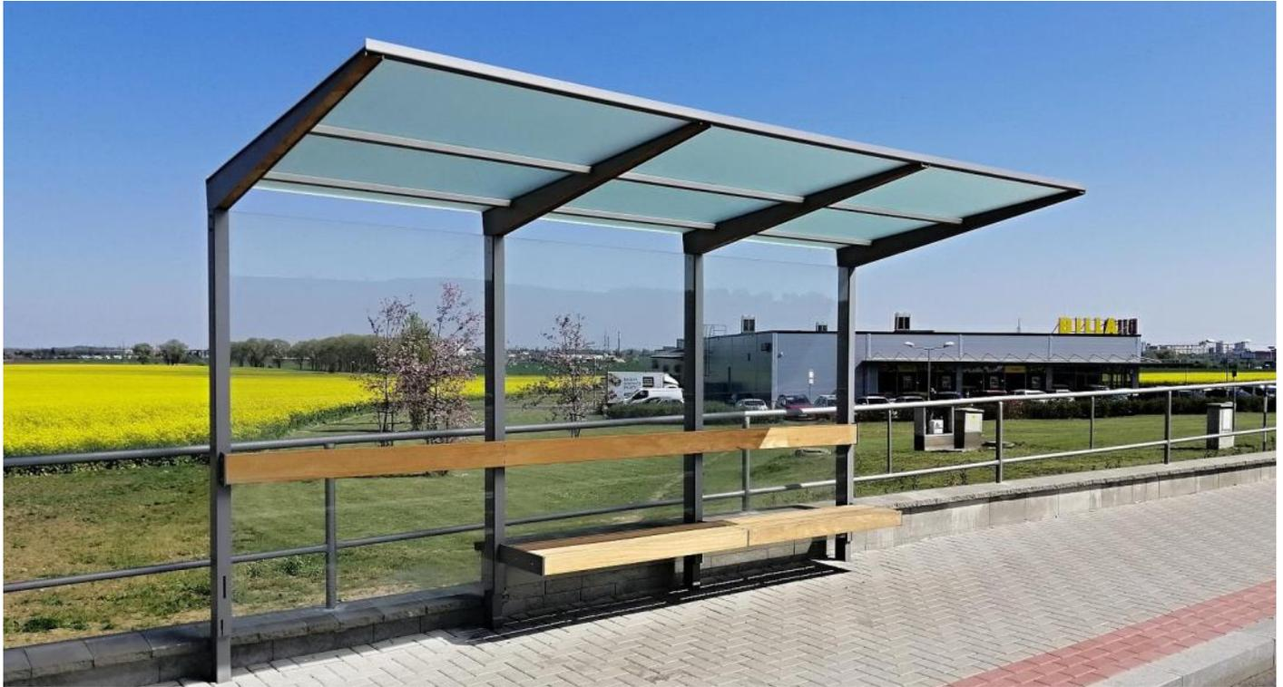
**Description :** Structure en acier galvanisé thermo laqué. La toiture est composée de panneaux en verre renforcé satiné de 8 mm d'épaisseur. La paroi arrière et les parois latérales de panneaux en verre clair renforcé de 8 mm d'épaisseur. L'assise des deux banquettes sont composées chacune de 3 planches en bois tropical ou en bois de pin. Les planches de bois sont assemblées à la structure par des boulons en acier inoxydable.
