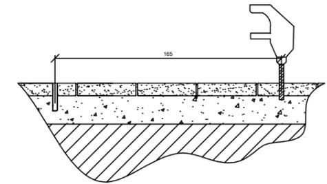
Percer deux trous l'un à côté de l'autre à une distance de 165cm
