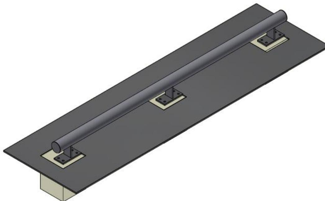
**Chasse-roues droit** Ø76mm Lg: 2,00m sur platine - DIMENSIONS : Ø76mm, longueur 2000mm, hauteur hors sol 160mm - MATERIAUX : Acier galvanisé
