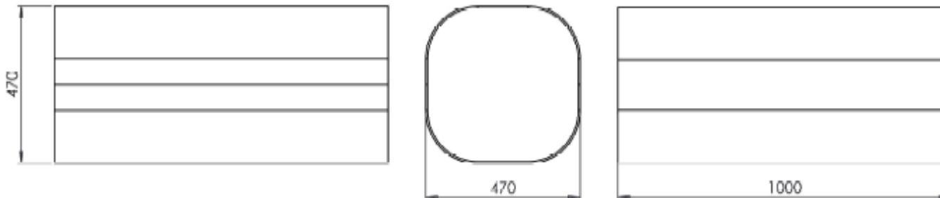
**Assise en acier galvanisé de 6 mm d'épaisseur thermolaquée de deux couleurs différentes (RAL au choix dans la palette de couleur standard). Elle peut être utilisée autant en extérieur comme en intérieur. Dimensions : 1000x470x470 mm. Installation : 4 tiges de scellement en acier inoxydable.**
