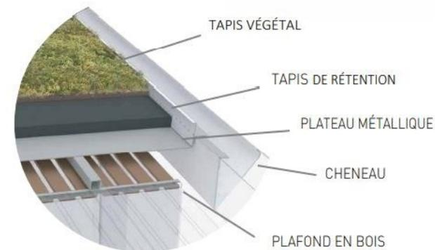
Le tapis de rétention est réalisé en panneaux fabriqués à partir de fibres polyester recyclées et de fibres fusibles. Il est fabriqué sans additifs chimiques et est entièrement recyclable.
