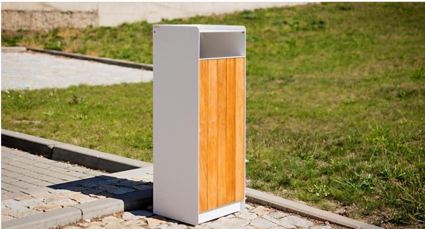
**Description :** Structure en acier galvanisé. L'habillage à l'avant est fait de 5 planches en bois (chêne, épicéa, bois exotique ou pin) mises à l'horizontale. La corbeille dispose d'une protection. Les côtés et l'arrière sont en acier galvanisé. Le bac en polypropylène de 5 mm d'épaisseur est amovible.
