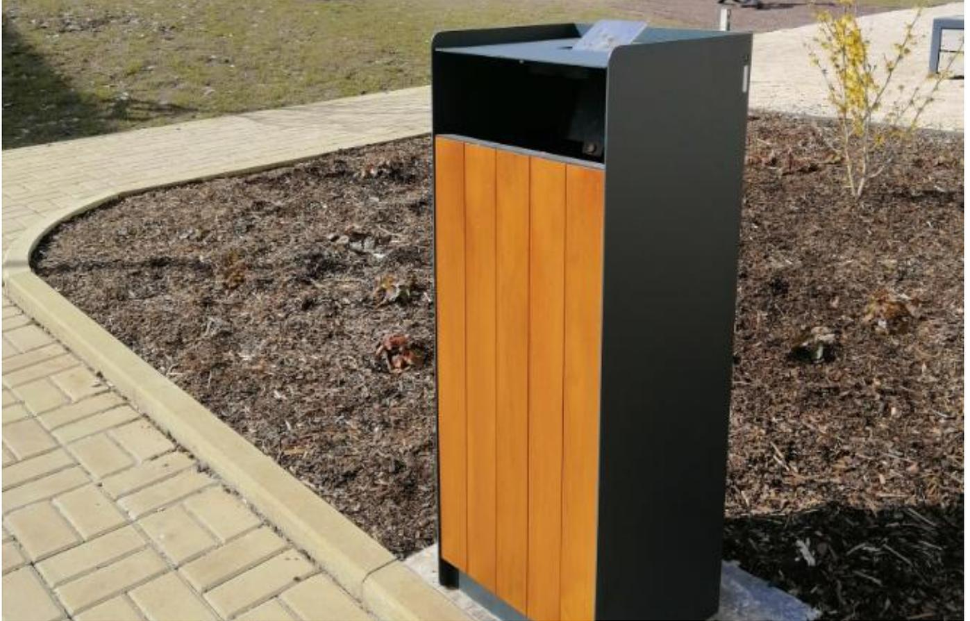
**Description :** Structure en acier galvanisé. La corbeille dispose d'une protection, d'un étouffoir à cigarettes d'un cendrier. L'habillage à l'avant est fait de 5 planches en bois (chêne, épicéa, bois exotique ou pin). Les côtés et l'arrière sont en acier galvanisé. Le bac en polypropylène de 5 mm d'épaisseur est amovible.
