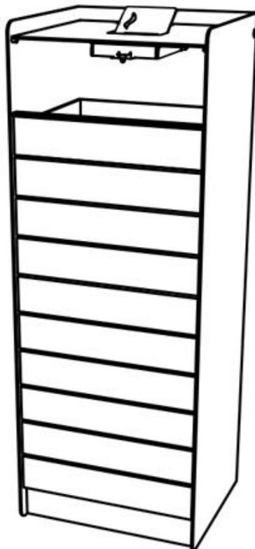
**Description :** Structure en acier galvanisé. La corbeille dispose d'une protection, d'un étouffoir à cigarettes et d'un cendrier. L'habillage à l'avant est fait de 10 planches en bois (chêne, épicea, bois exotique ou pin) mises à l'horizontale. Les côtés et l'arrière sont en acier galvanisé. Le bac en polypropylène de 5 mm d'épaisseur est amovible.
