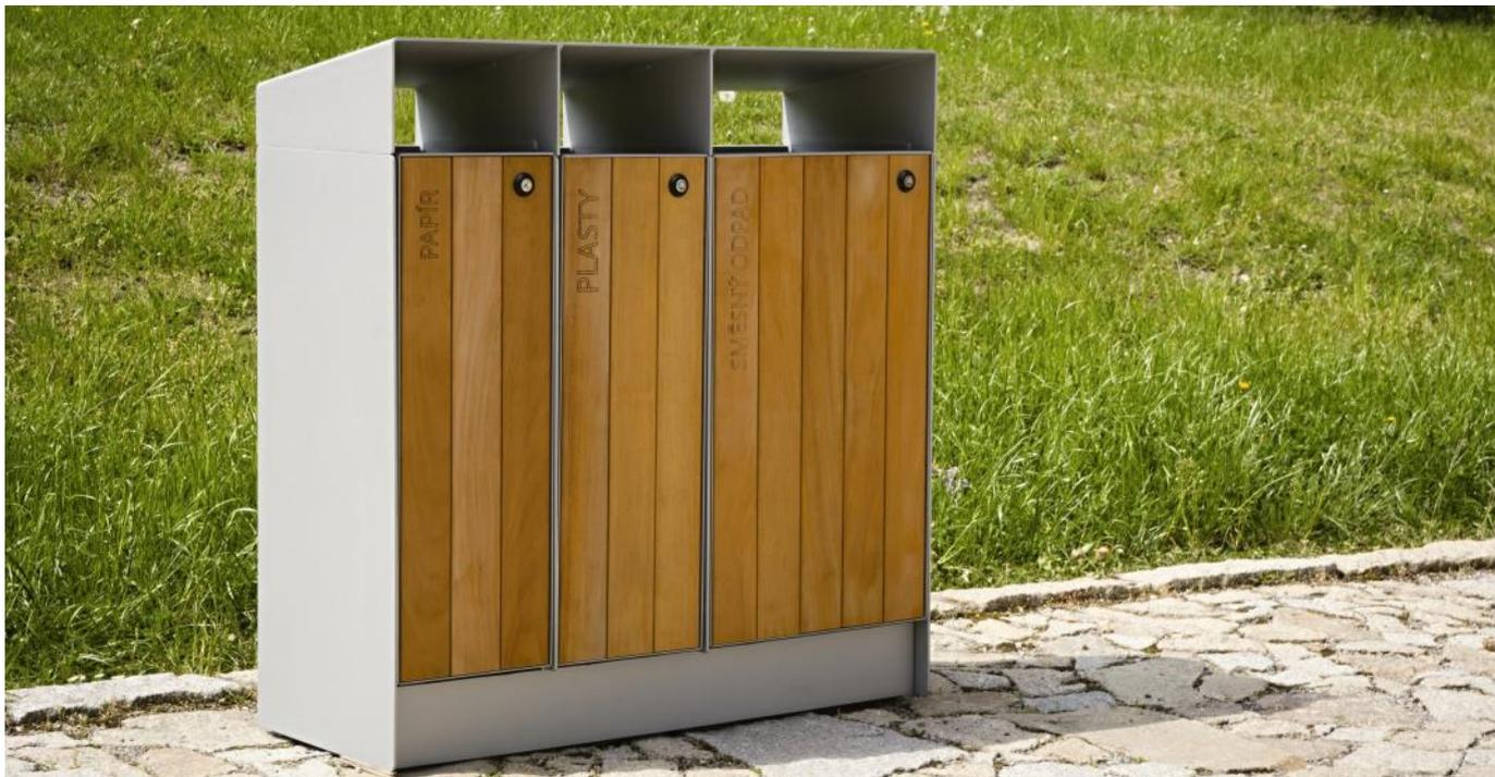
**Description :** 3 corbeilles de tri sélectif. Structures en acier galvanisé. Les portes des corbeilles sont fait de planches en bois de : Chêne, Épicéa, Pin thermo traité ou Bois Tropical. L'ouverture des la corbeilles se fait par l'avant, les portes dispose d'une fermeture par clé. Les bacs en acier galvanisé de 5 mm d'épaisseur sont amovibles.
