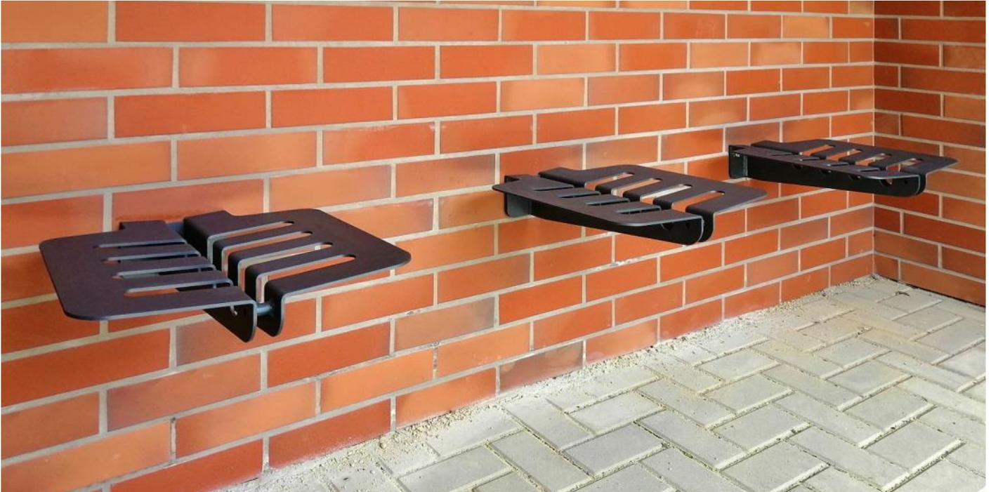
**Description** : Banquette murale. Structure en acier galvanisé thermolaqué. L'assise est composée de deux parties en tôle d'acier soudés ensemble. La fixation se fait au mur sur platines avec 3 tiges d'ancrage M10.
