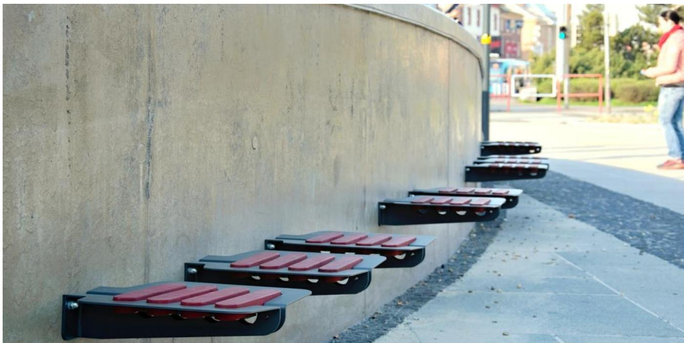
**Description :** Banquette murale. Structure en acier galvanisé thermolaqué. L'assise est composée de deux parties en tôle d'acier soudés ensemble ainsi que des lattes en bois tropical. La fixation se fait au mur sur platines avec 3 tiges d'ancrage M10.
