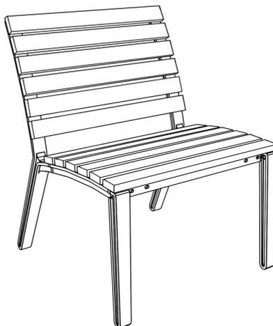
**Description** : Structure en aluminium thermolaqué. Le dossier et l'assise sont composés respectivement de 6 planches en bois de : chêne, épicea ou bois tropical. Les planches de bois sont assemblées à la structure par des boulons en acier inoxydable.
