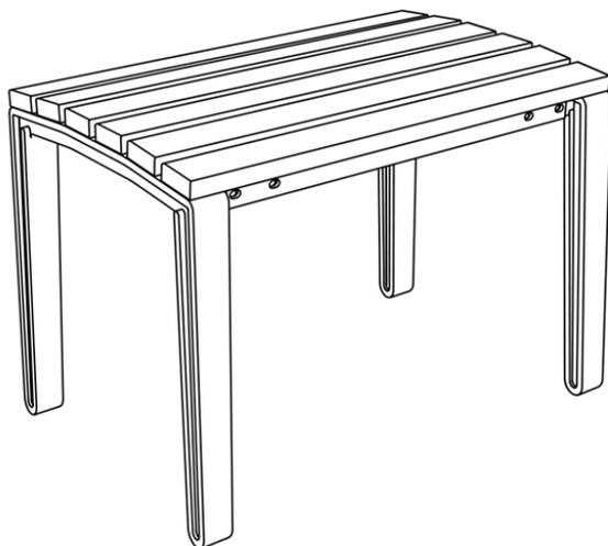
**Description** : Structure en aluminium thermolaqué. L'assise est composée de 6 planches en bois d'acacia. Les planches de bois sont assemblées à la structure par des boulons en acier inoxydable.
