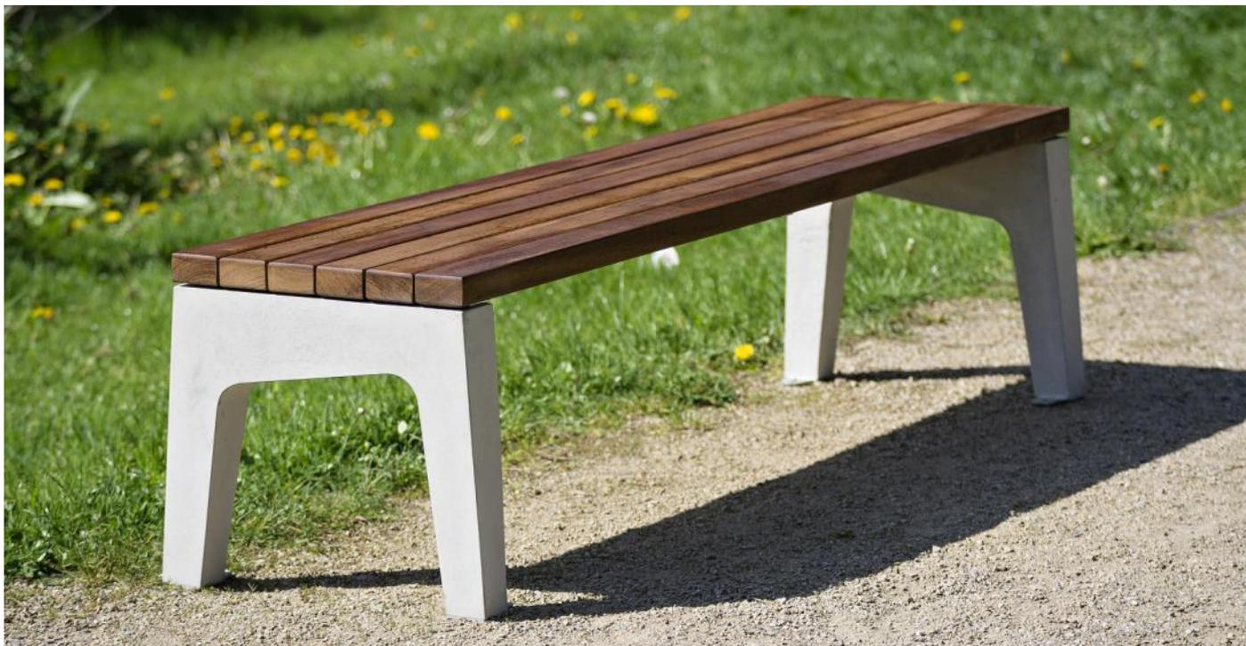
**Description :** Banquette en bois de pin avec piètements en béton C30/37. Structure en acier galvanisé reliant les piètements béton. Assise composée de 5 lames de bois de 70x40mm fixées à la structure par des vis inox M8.
