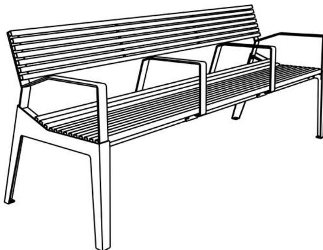
**Description** : Banc avec 4 accoudoirs. Structure en acier galvanisé. L'assise est composée de 13 lames en acier galvanisé. Le dossier est composé de 7 lames en acier galvanisé.
