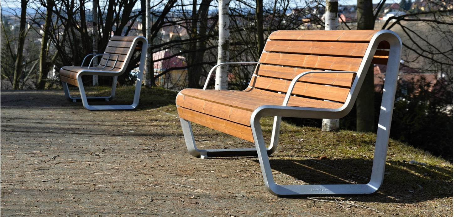
**Description :** Structure en aluminium **thermolaqué**. Le dossier et l'assise sont composés respectivement de 10 planches de section rectangulaire et 6 planches cintrées en bois de : chêne, épicéa ou bois tropical. Les planches de bois sont assemblées à la structure par des boulons en acier inoxydable. Le banc possède deux accoudoirs aux extrémités.
