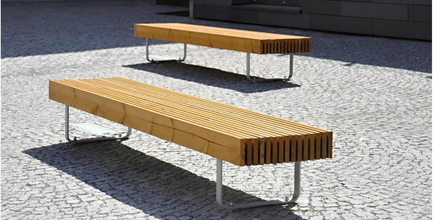
**Description** : Structure en acier galvanisé. L'assise est composée de 15 lames rectangulaires en pin. Les lames sont mises à la verticale de dimension 26x140x3000mm.
