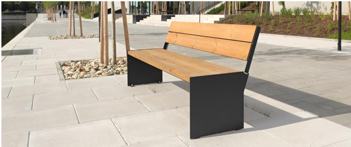
**Description :** Structure et piétement en acier galvanisé thermo laqué. Les piétements de 6 mm de large sont soudés au cadre du banc de profile 40x40 mm. Le dossier et l'assise sont composés respectivement de 2 planches rectangulaire de 140x42 mm et 3 planches rectangulaire de 140x42 mm en bois d'épicéa. Les planches de bois sont assemblées à la structure par des boulons en acier inoxydable.
