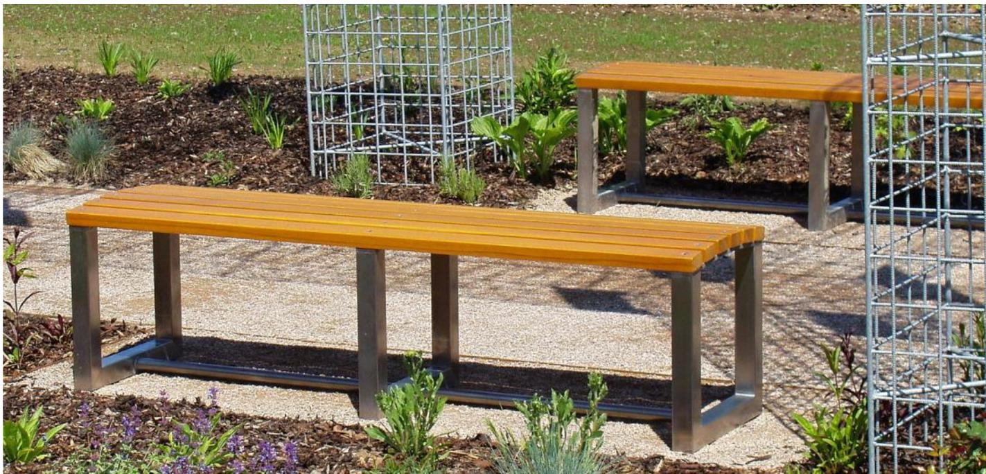
**Description :** Structure en aluminium thermo laqué. L'assise est composée de 6 lames de bois (56x42mm) : chêne, épicéa, bois tropical ou pin. Les planches de bois sont assemblées à la structure par des boulons en acier inoxydable.
