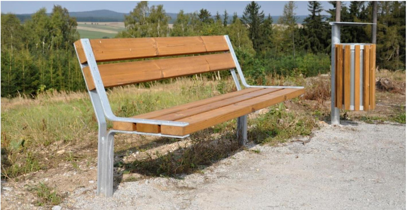
**Description :** structure en acier galvanisé composée de profils acier de 50x10mm composant les piètements - 3 planches de bois de 42x117mm pour l'assise et 2 planches de bois de même dimensions pour le dossier - Les planches sont fixées entre les lames d'acier par un boulonnage de type M8
