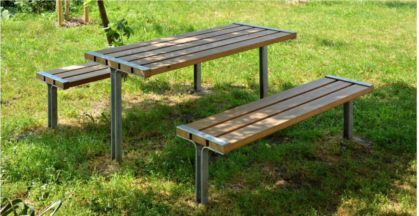
**Description :** structure en acier galvanisé composée de profils acier de 50x10mm composant les piètements - 3 planches de bois de 42x117mm pour l'assise - Les planches sont fixées entre les lames d'acier par un boulonnage de type M8
