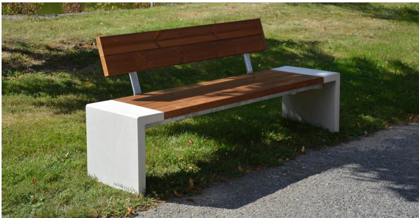
**Description :** structure en acier galvanisé de 4mm reliant les piétements en béton C35/45 -assise et dossier composée 6 planches de bois de 42x117mm pour 1430mm de long fixées à la structure par vis inox M8 .
