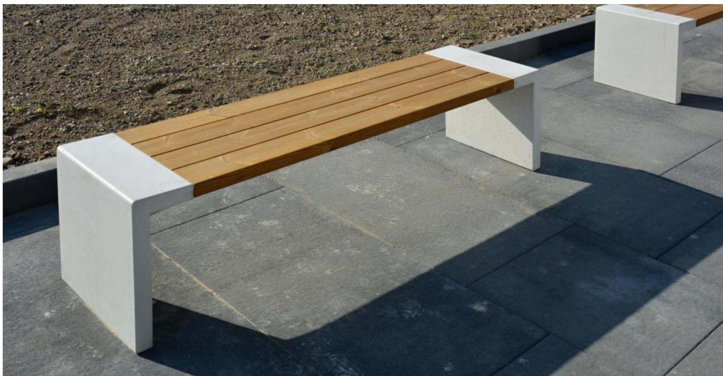
**Description** : structure en acier galvanisé de 4mm reliant les piètements en béton C35/45 -assise composée 4 planches de bois de 42x117mm pour 1430mm de long fixées à la structure par vis inox M8 .
