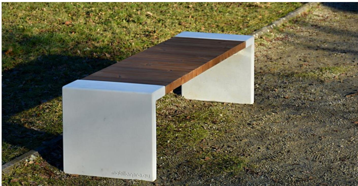
**Description** : structure en acier galvanisé de 4mm reliant les piétements en béton C35/45 - assise composée de 10 planches de bois de 42x117mm et 5 planches de 42x92mm pour une longueur de 468mm - elles sont fixées à la structure par vis inox M8.
