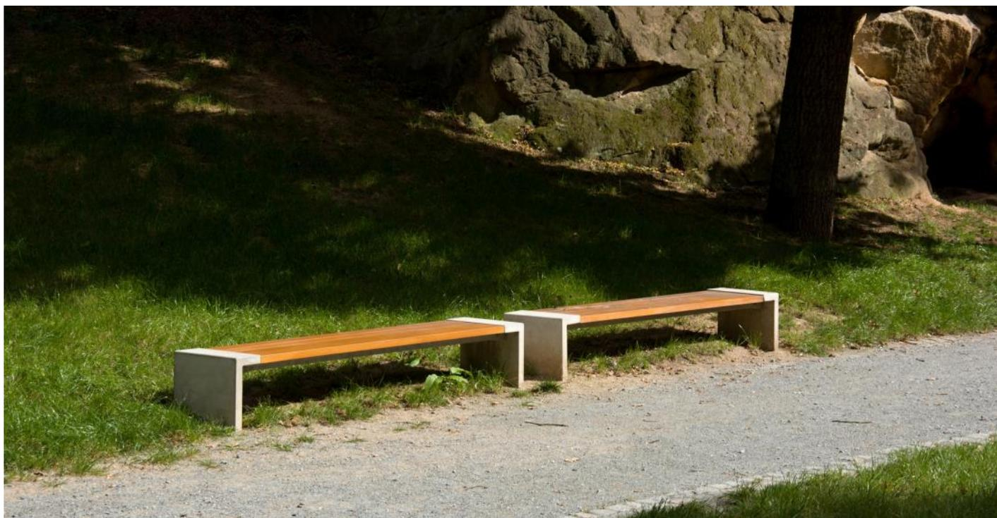
**Description** : structure en acier galvanisé de 4mm reliant les piétements en béton C35/45 - assise composée 4 planches de bois de 42x117mm pour 2030mm de long fixées à la structure par vis inox M8
