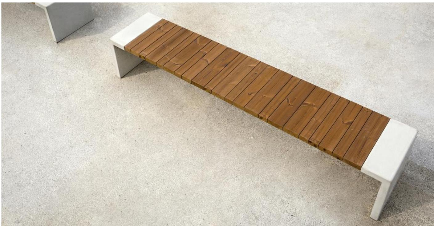
**Description** : structure en acier galvanisé de 4mm reliant les piètements en béton C35/45 - assise composée de 8 planches de bois de 42x117mm - 4 planches de 42x92mm et 10 planches de 42x68mm pour une longueur de 468mm - elles sont fixées à la structure par vis inox M8
