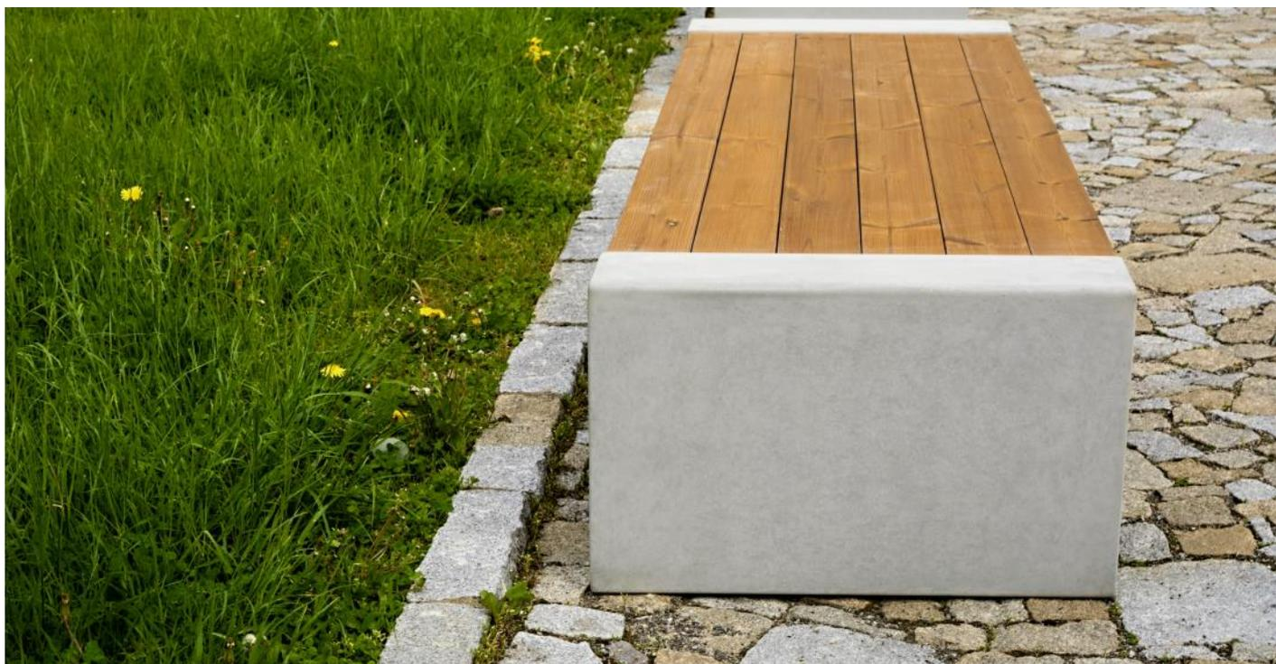
**Description** : structure en acier galvanisé de 4mm reliant les piétements en béton C35/45 - assise composée 6 planches de bois de 42x117mm pour 1430mm de long fixées à la structure par vis inox M8
