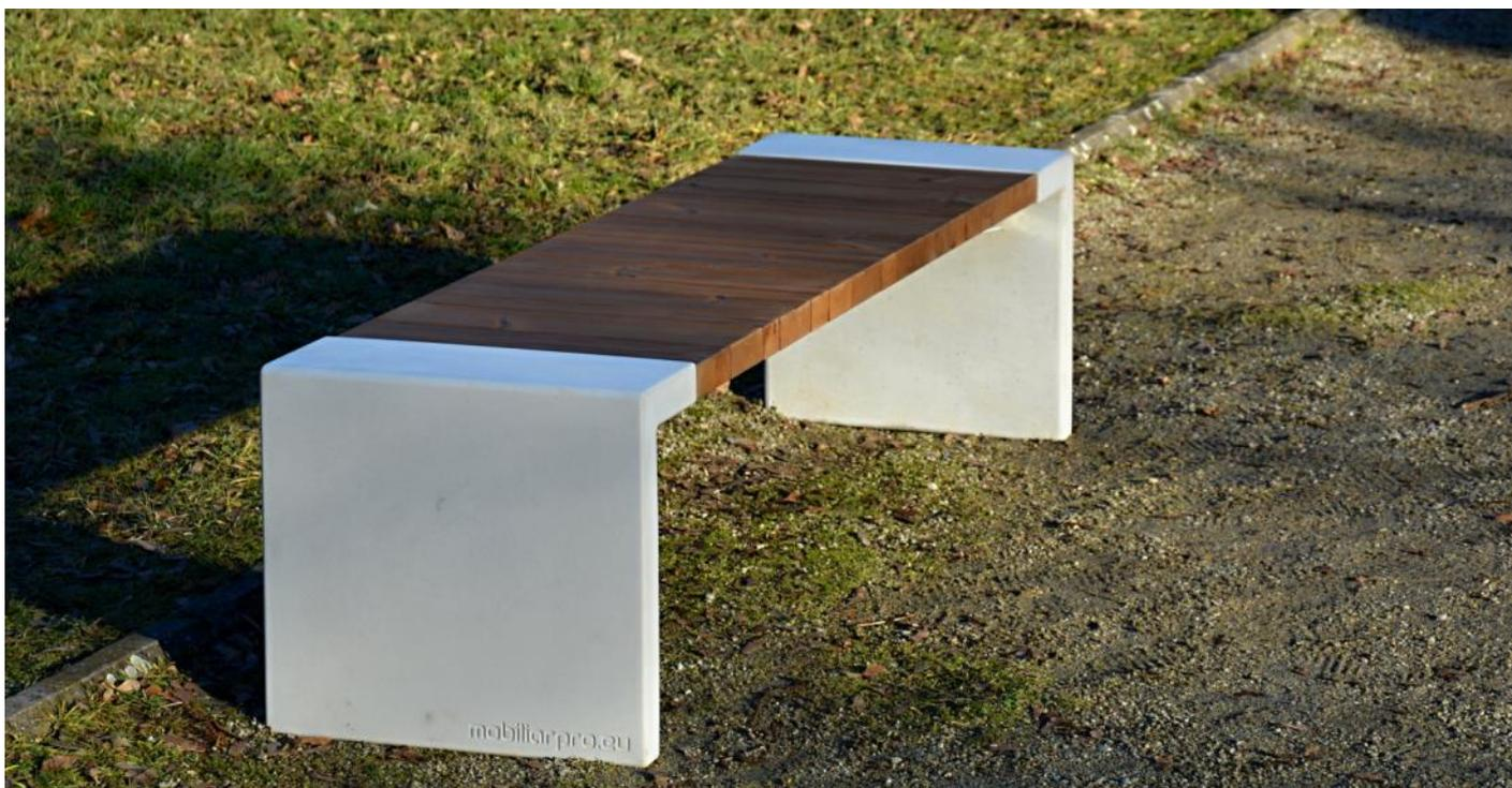
**Description** : structure en acier galvanisé de 4mm reliant les piètements en béton C35/45 - assise composée de 7 planches de bois de 42x117mm - 2 planches de 42x92mm et 5 planches 68x42mm pour une largeur de 712mm - elles sont fixées à la structure par vis inox M8
