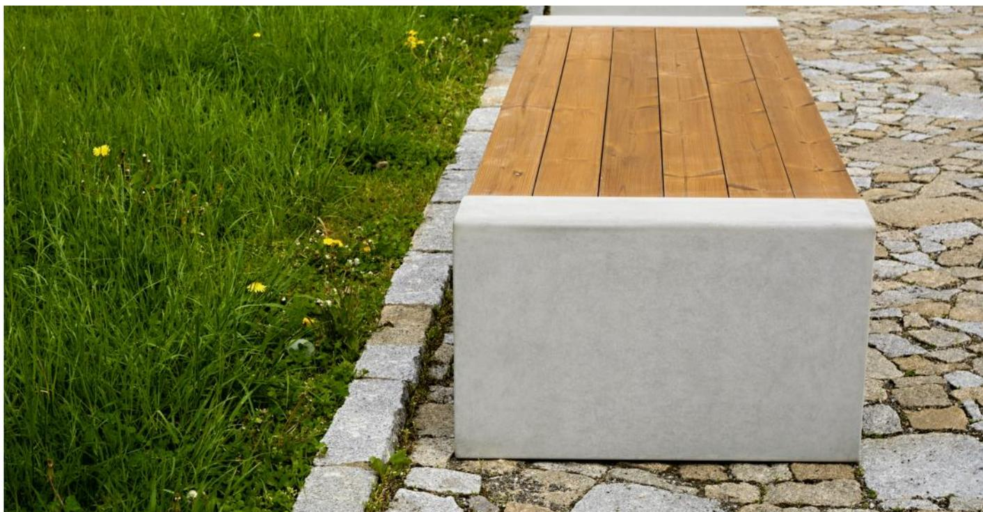
**Description :** structure en acier galvanisé de 4mm reliant les piétements en béton C35/45 - assise composée 6 planches de bois de 42x117mm pour 2030mm de long fixées à la structure par vis inox M8
