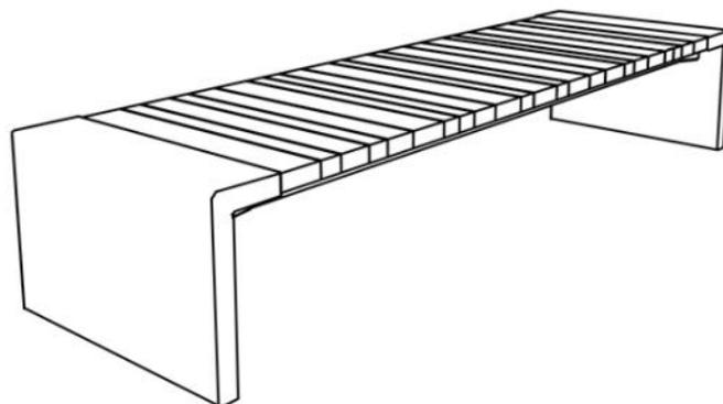
**Traitement du bois :** épicéa imprégné avec deux couches et laqué avec un mélange d'eau et de cire d'abeille. Bois tropical avec de l'huile de teck. Chêne avec traitement de surface. Bois de pin thermo-modifié ThermoWood® - avec protection UV.
