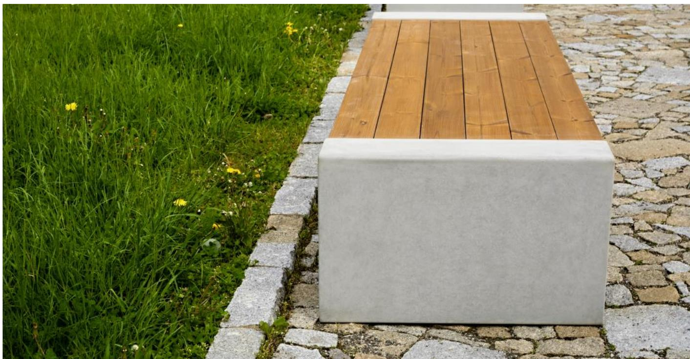
**Description :** Banquette ODAG - structure en acier galvanisé de 4mm reliant les piètements en béton C35/45 - assise composée au total de 22 planches de bois dont 8 de 42x117mm - 4 planches de 42x92mm et 10 planches de 42x68mm pour une longueur de 468mm - elles sont fixées à la structure par vis inox M8.
