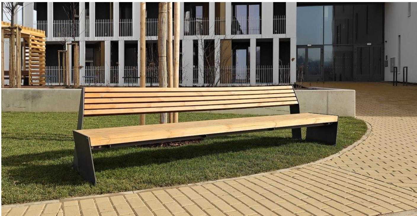
**Description** : Structure en acier soudé. Piétements en tôle d'acier de 4 et 6 mm d'épaisseur. L'assise et le dossier sont composés respectivement de 9 et 5 lames en bois de Pin thermo traité ou Bois Tropical. Les planches de bois sont assemblées à la structure par des boulons en acier inoxydable.
