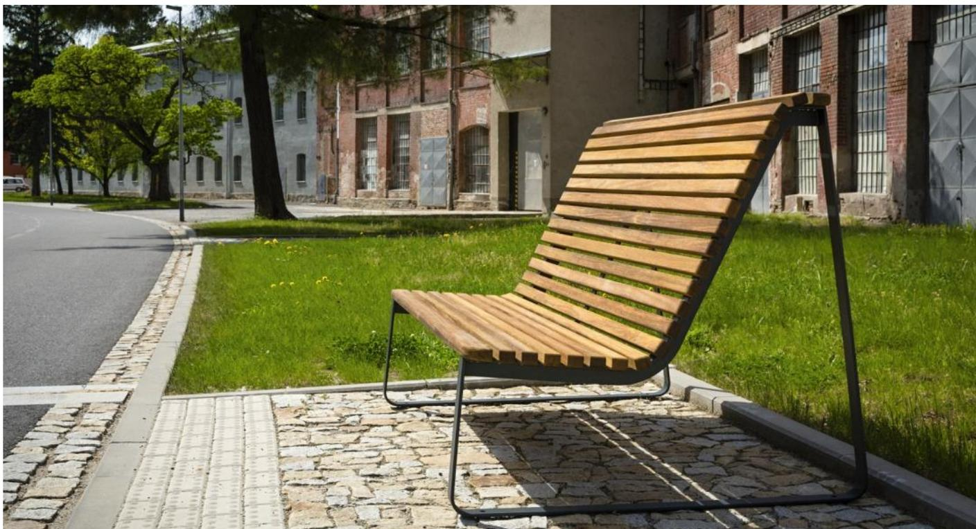
**Description** : Structure en acier soudé. Les piétements sont composés de deux rails soudés à partir d'une bande pliée de 50x8 mm et de tôle de 5 mm d'épaisseur. L'assise et le dossier sont composés de 2 lames rectangulaire de 70x 32x1800 mm et de 21 lames rectangulaire de 40x32x1800 mm en bois tropical traité. Les planches de bois sont assemblées à la structure par des boulons en acier inoxydable.
