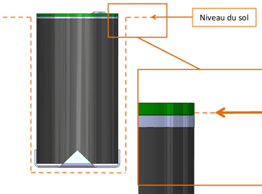
Pour les dimensions du carottage, on veillera à laisser un espace suffisant en dessous et autour pour l'insertion de la borne. Il faut laisser environ 4 centimètres en profondeur et 1 centimètre tout autour (soit environ 2 centimètre au diamètre).
