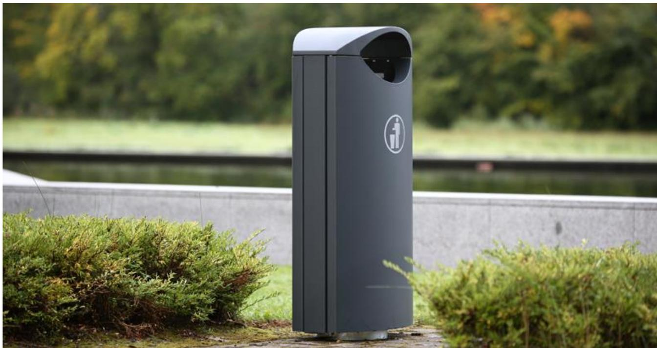
**Description** : Structure en acier galvanisé à chaud s355 de 3 mm d'épaisseur (panneaux et latéraux) et 4mm (base et éléments intérieurs de renforcement) peint polyester. Cendrier incorporé. Partie supérieure en aluminium. Bac intérieur en acier galvanisé ou en plastique renforcé. Piétement muni d'un système de nivellement. Ouverture frontale. Tiges d'ancrage en acier inoxydable M12x180mm.
