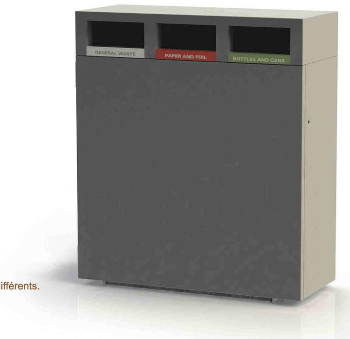
**Description :** Structure en acier galvanisé à chaud et habillage en aluminium avec finition par peinture en poudre cuite au four. Porte avec charnières pleines en acier inoxydable, robuste et situées dans le renforcement de la porte. Loquet antidérapant. Trois bacs galvanisés de 75L. Deux ouvertures à l'avant du bac pour les différents flux de déchets.
